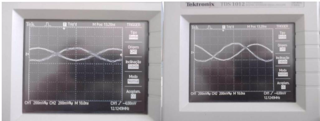
Figura 23: Apresentação das fases relativas entre entrada e saída de sinal, obtidas com a montagem experimental do circuito modulador de fase.
