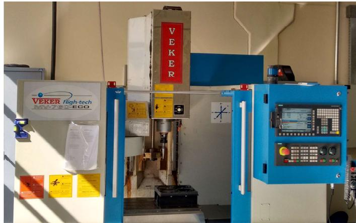
Figura 32: Centro de usinagem CNC de 3 eixos.
