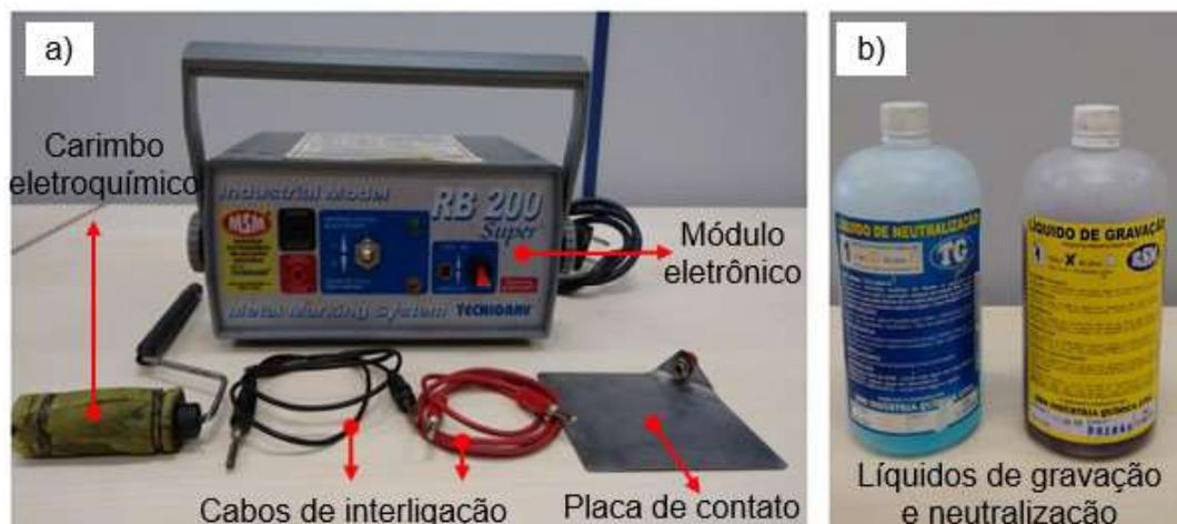
Figura 33: Sistema de marcação de metais Tecnigrav.
