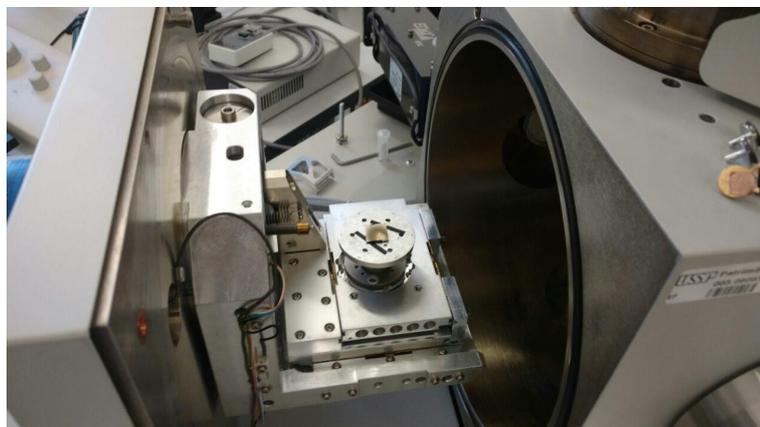
Figura 25 – Amostra após a remoção do baquelite. PMT – EPUSP.
