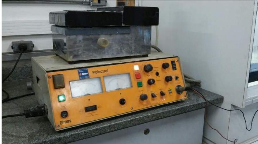
Figura 20 – Máquina de ataque químico eletrolítico. PMT – EPUSP
