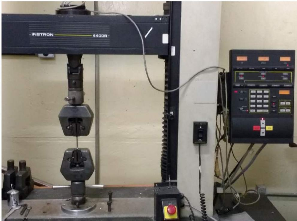
Figura 28 – Máquina de Ensaio de Tração Instron, com CP1 em desenvolvimento.
