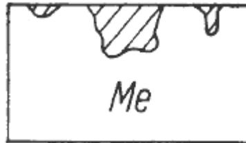
Figura 17 – Corrosão por pite.
