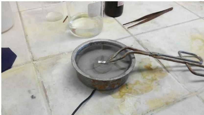
Figura 21 – Ataque eletrolítico com reagente químico HCl (10%) em amostra embutida em resina pós análise no MEV. PMT – EPUSP
