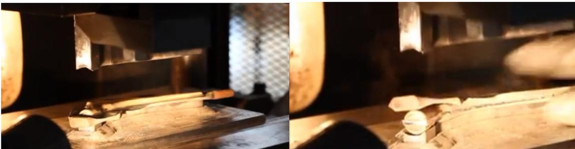
Figura 14 – a) Conjunto punção/matriz. b) Processo de remoção da rebarba.
