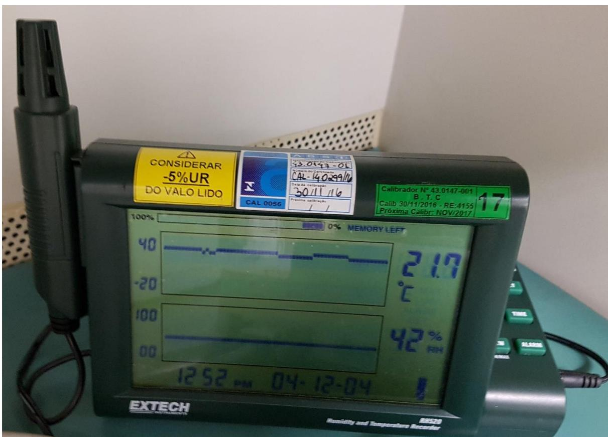
Figura 65 – Sensor de Umidade Relativa
