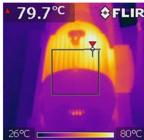
Figura 48 – Temp. de Operação Motor de 25CV (Sistema Antigo)
