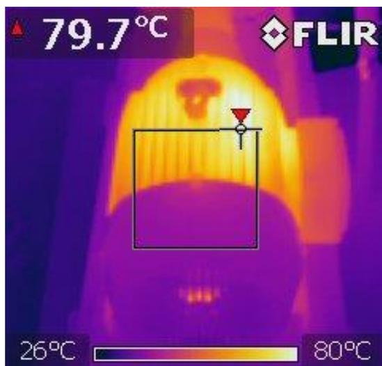
Figura 96 – Temperatura de Operação do Motor Elétrico de 25CV (antes)
