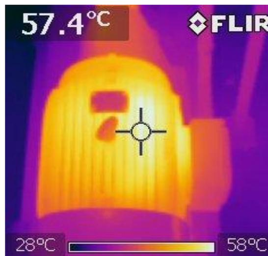
Figura 97 – Temperatura de Operação do Motor Elétrico de 25CV (depois)
