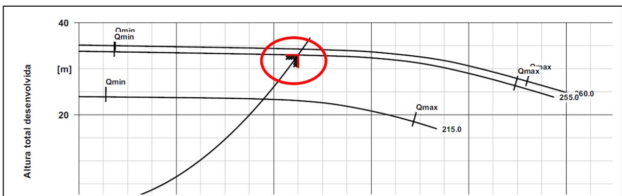
Figura 57 – Curva (*Head*) Bomba Ramo Casa de Máquinas versus Curva Característica do Sistema
