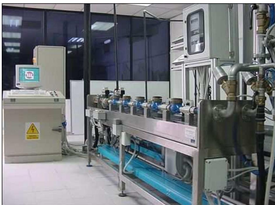
**Figura 13** Banco de provas eletrônico produzido pela empresa Maddalena. Fonte: Hidrobolivar (2007).
