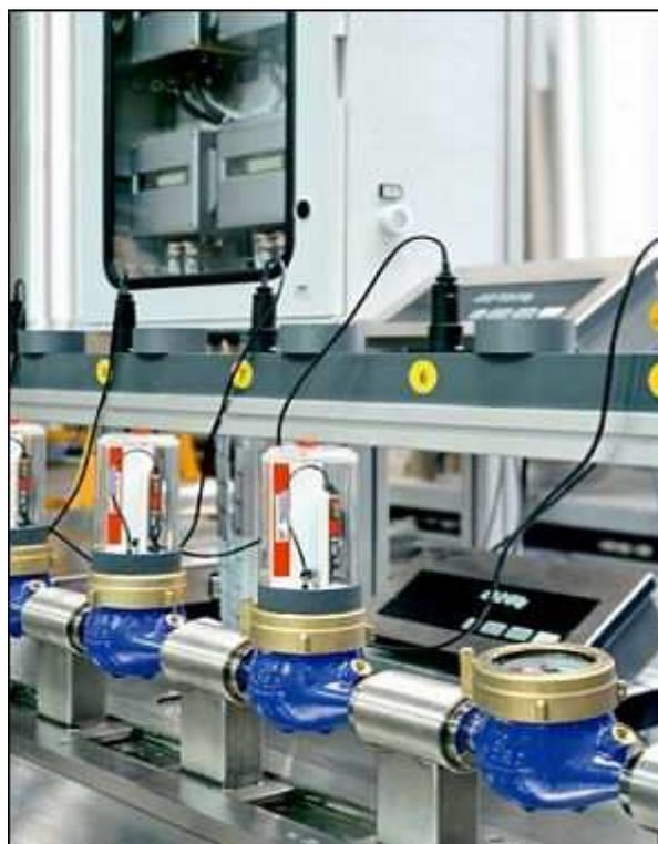
**Figura 14:** Cabeças de leitura optoeletrônicas do banco de provas Maddalena.
