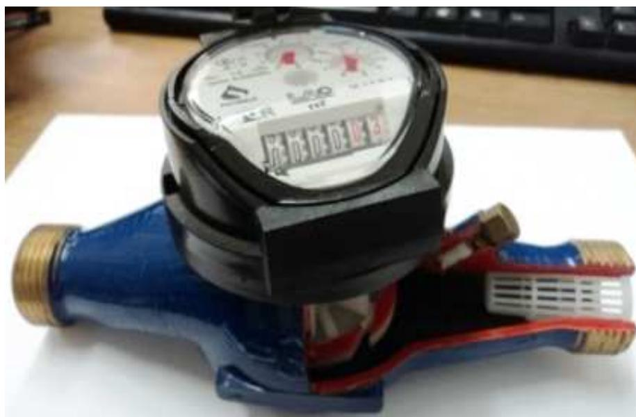
**Figura 22:** Fotografia do medidor com a região da entrada cortada para visualização da câmara e mecanismo de regulação.
