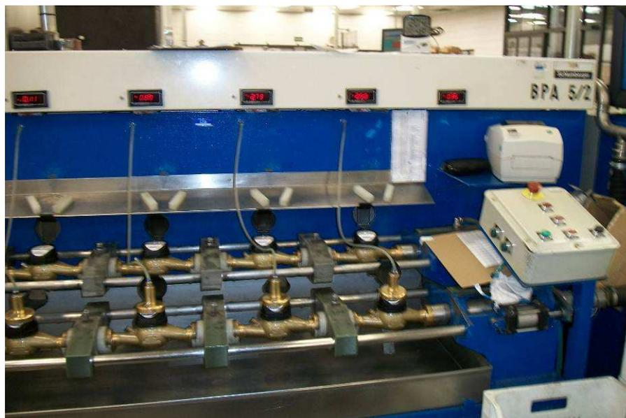
**Figura 11:** Vista das rampas de aferição de hidrômetros do banco BPA – 5/2 da empresa Itron (Espanha).
