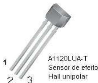
**Figura 40:** Aspecto externo do sensor de efeito hall. Terminal 1 é a alimentação Vcc de 3 a 24 V, terminal 2 é o terra e o terminal 3 é a saída. Fonte: Allegro *datasheet*.
