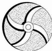
Figura 2.5 – Rotor Semi-aberto. Fonte Slideplayer.
