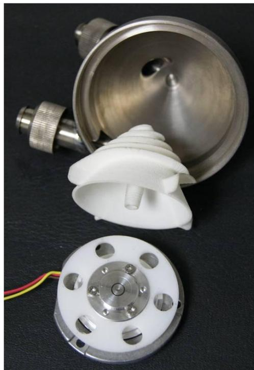
Figura 2.8 – Foto da BSCI e detalhe do cone externo da BSCI em titânio, rotor em poliamida e motor BLDC.
