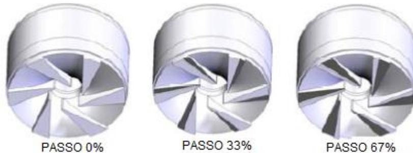
Figura 2.7 - Três tipos de rotores testados cujo comprimento do passo foi de 0%, 33% e 67% do comprimento da aleta.
