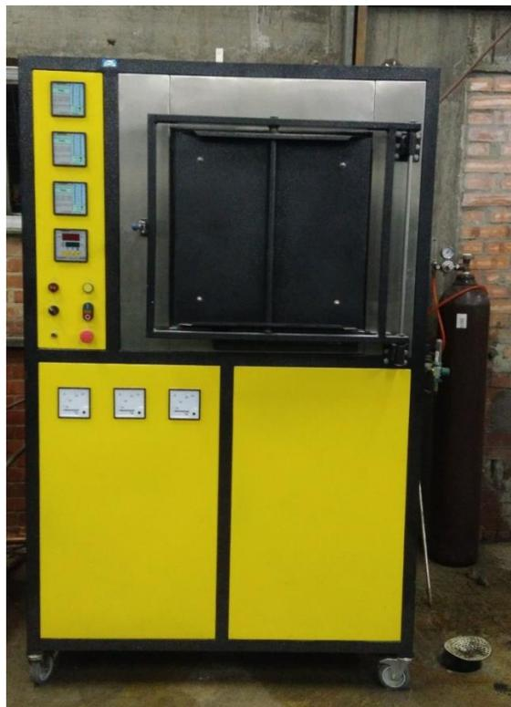
Figura 18 - Forno elétrico tipo mufla acoplado a um cilindro de argônio.
