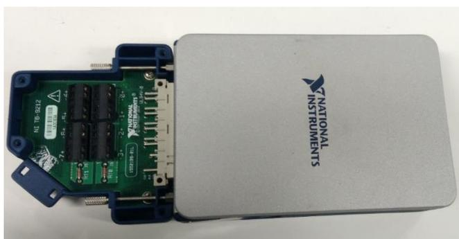
Figura 21 - Aquisitor de dados (módulo e chassi já acoplados) com 8 canais e saída USB da marca National Instruments.
