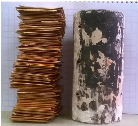
Figura 16 - Bronze UNS C50700 cortado em quadrados de aproximadamente 55 mm de lado e empilhado junto à lingoteira.
