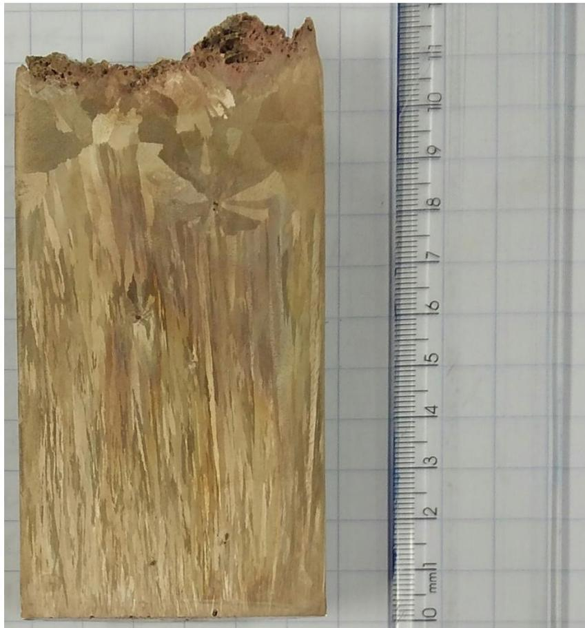
Figura 25 - Macrografia do lingote da liga Cu-8,5%Sn obtido por solidificação unidirecional ascendente. Reagente: 52 g de  $\text{FeCl}_3$ , 325 mL de HCl, e  $\text{H}_2\text{O}$  destilada suficiente para completar 1 litro de solução. Obteve-se uma zona colunar com quase 80 mm de comprimento.
