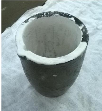
Figura 17- Cadinho de carbetto de silício logo após ser revestido com uma mão de cimento refratário.
