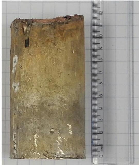
Figura 22 - Lingote da liga Cu-8,5%Sn depois de rebarbado.
