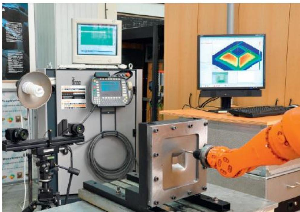
Figura 17 – Robô utilizado em *SPIF*.
