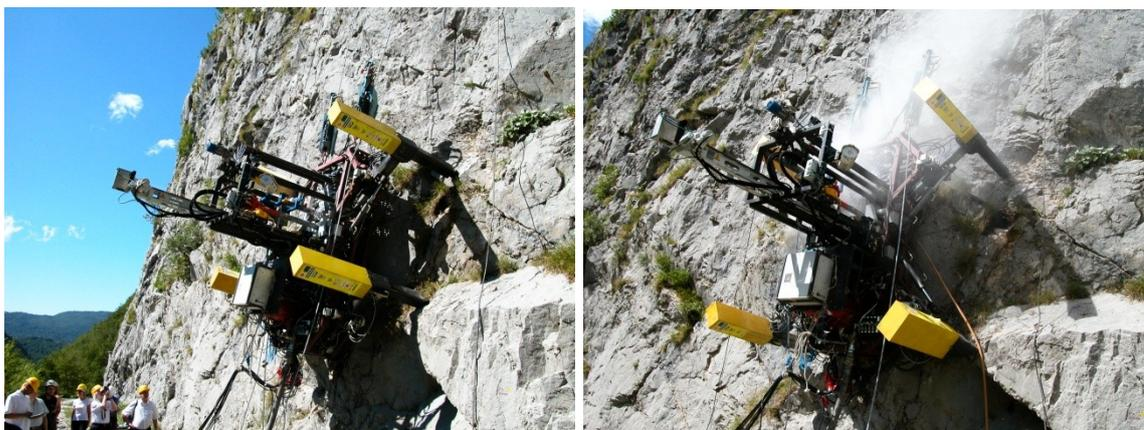
Figura 2.7: ROBOCLIMBER se posicionando em uma encosta rochosa para realizar uma operação de perfuração no solo.
