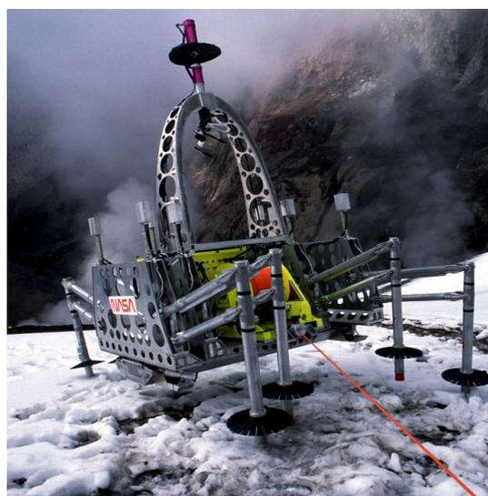
Figura 2.5: DANTE-II explorando o monte Spurr (Alasca) em 1994, medindo gases, temperaturas e monitorando o interior da cratera.
