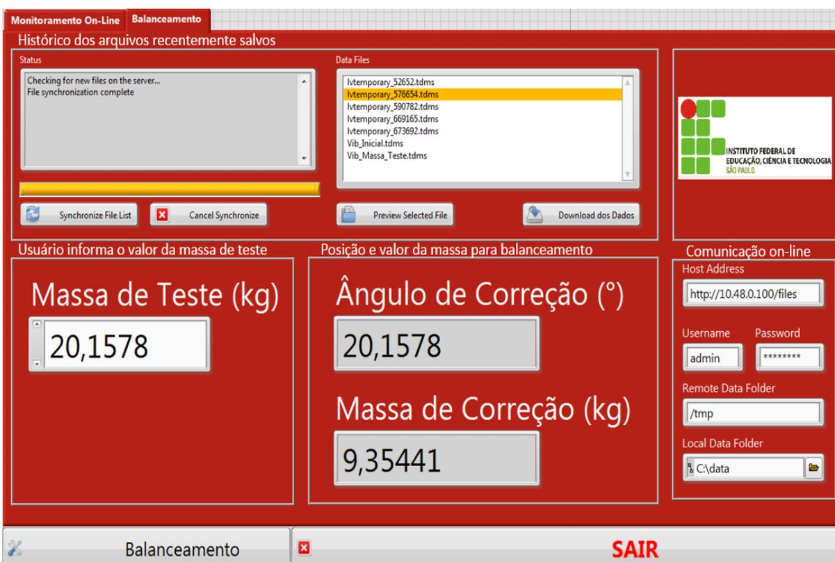
Figura 44. Interface para cálculos do ângulo e do valor da massa de correção. (Fonte: Autoria própria).
