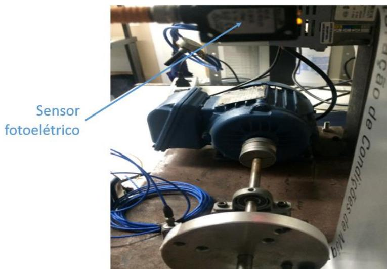
Figura 25. Posição do sensor fotoelétrico montado para medir a rotação no disco. (Fonte: Autoria própria).
