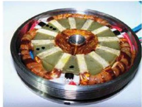
Figura 10 – Bomba de sangue centrífuga totalmente implantável e seu motor.
