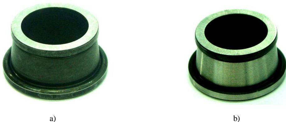
Figura 3.3 – a) Anel interno bruto e b) Anel interno com pista e borda retificados
