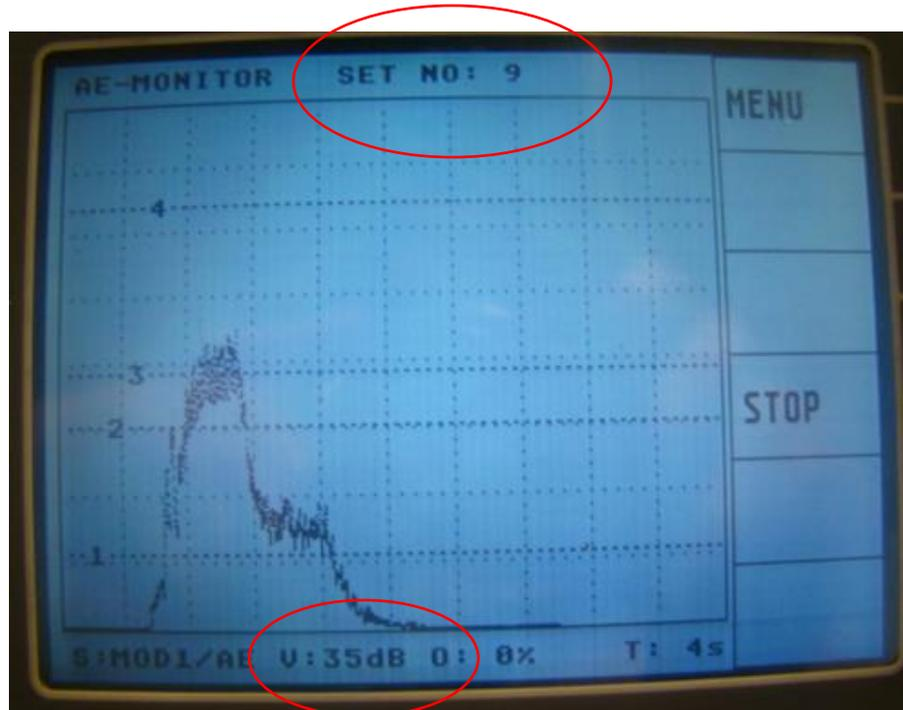
Figura 3.18 – Equipamento de monitoramento do ciclo de retífica em operação. Foto do dia 06/02/2013
