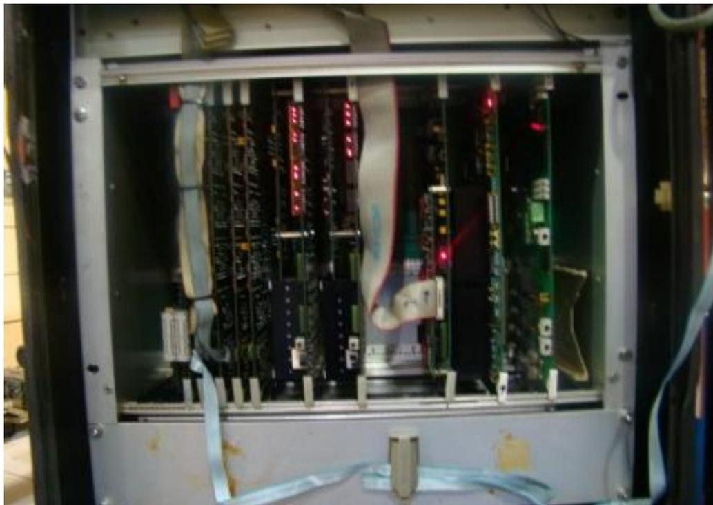
Figura 3.4 – Gabinete (rack) do MTC com as placas eletrônicas que compõem o sistema de controle
