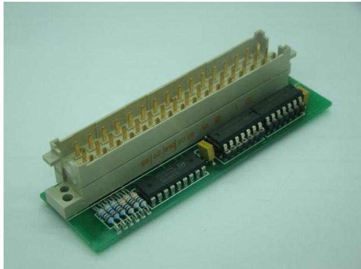
Figura 3.9 – Placa eletrônica utilizada para amplificar os sinais de corrente elétrica de saída do sistema numérico MTC
