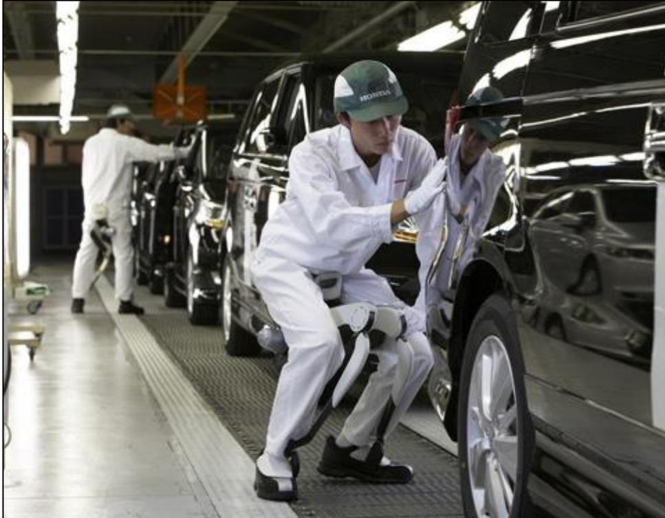
Figura 1.13 – Exoesqueleto aplicado em manufatura
