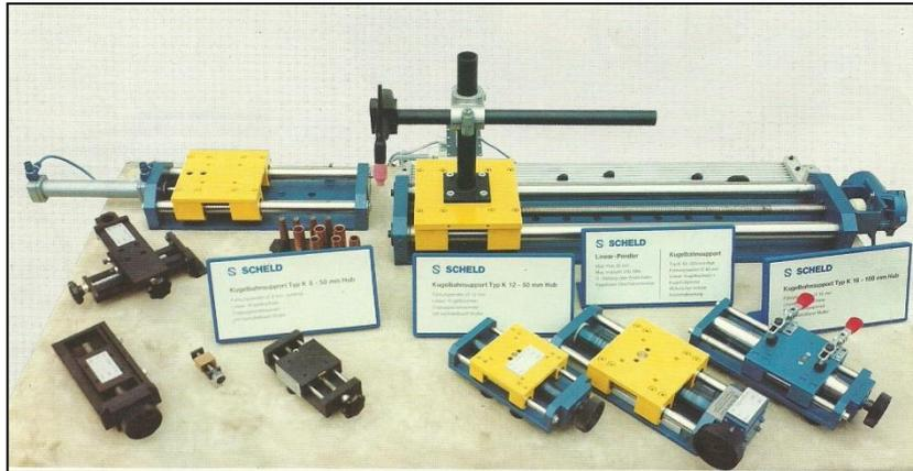
Figura 1.6 – Posicionadores para dispositivos de soldagem
