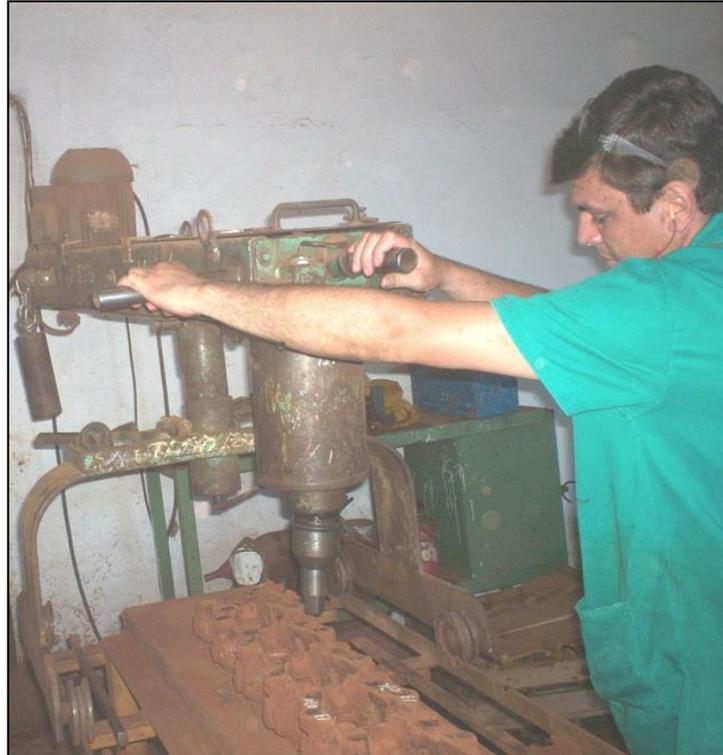
Figura 1.2 – Parafusadeira pneumática com contrapeso
