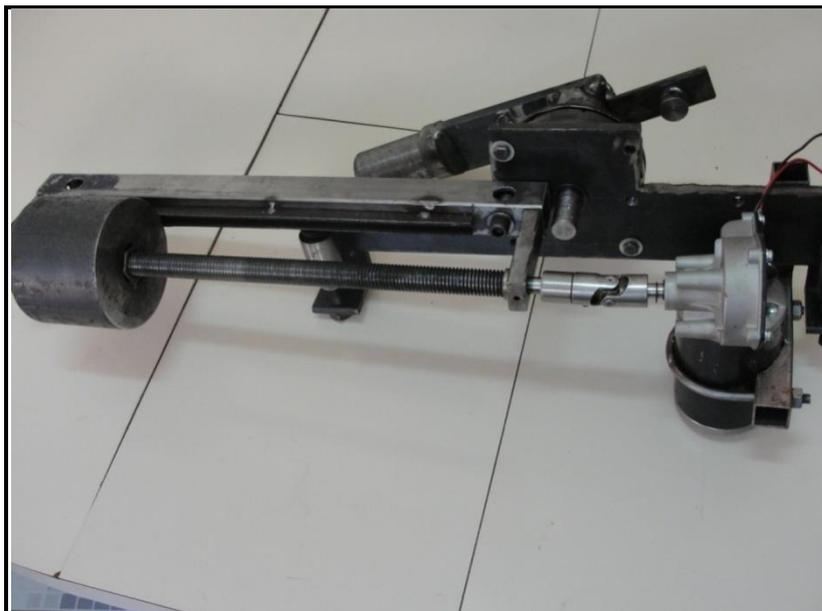
Figura A.11 - Mecanismo de movimentação do contrapeso
