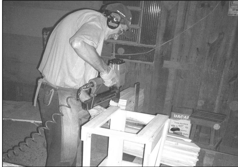
Figura 1.1 – Utilização de grampeador pneumático
