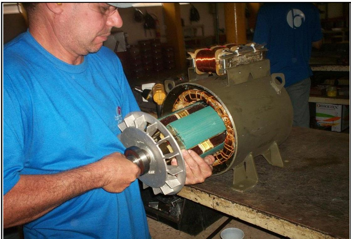
Figura 1.4 – Montagem do rotor
