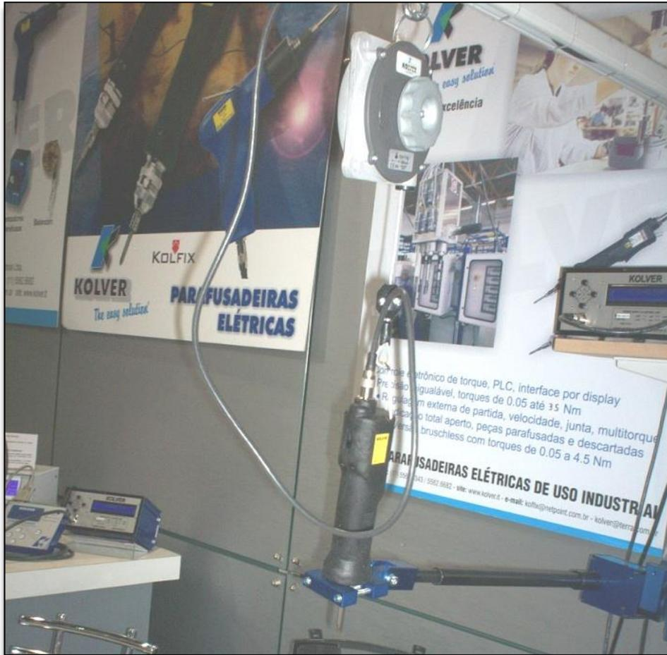
Figura 1.7 - Balancim suporte de parafusadeira
