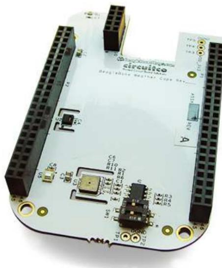
Figura 30: Placa de aquisição *BeagleBone Weather Cape*
