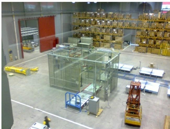
Figura 24: WHV- Estação de teste de tensão aplicada em linha de montagem de painéis elétricos
