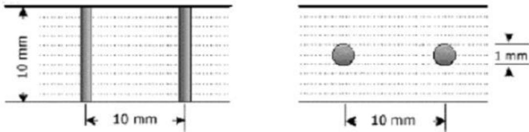
**Figura 9 - Geometria e disposição dos Condutores do Eletrodo (DE LUCA, 2002).**
