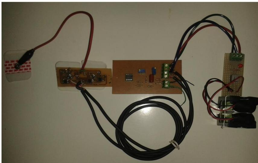
**Figura 28 - Protótipo de um canal e sensor ativo e placa amplificadora.**
