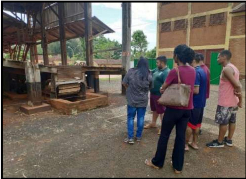
**FOTOGRAFIA 5:** Esteira e bancada em madeira nobre, construídas para a lavagem da cana de açúcar. Vemos na área inferior do maquinário a parte conhecida como “despela porco”.
