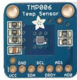
Figura 22 – Adafruit® Thermopile Sensor
