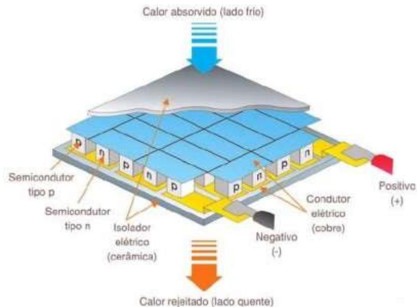
**Figura 10 - Composição de uma placa de Peltier.**
