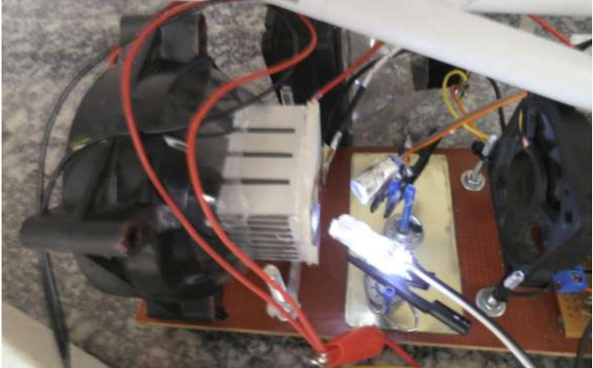
**Figura 34 - Montagem dos dispositivos de emissão e detecção de luz**
