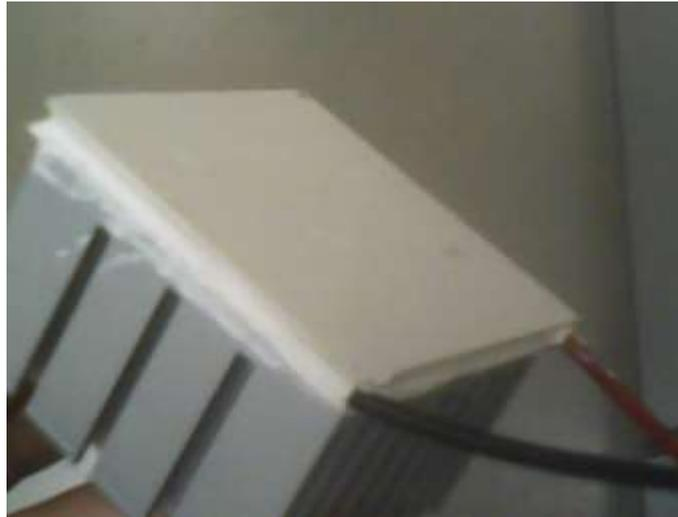
**Figura 23 – Montagem do dissipador de calor na placa de Peltier.**
