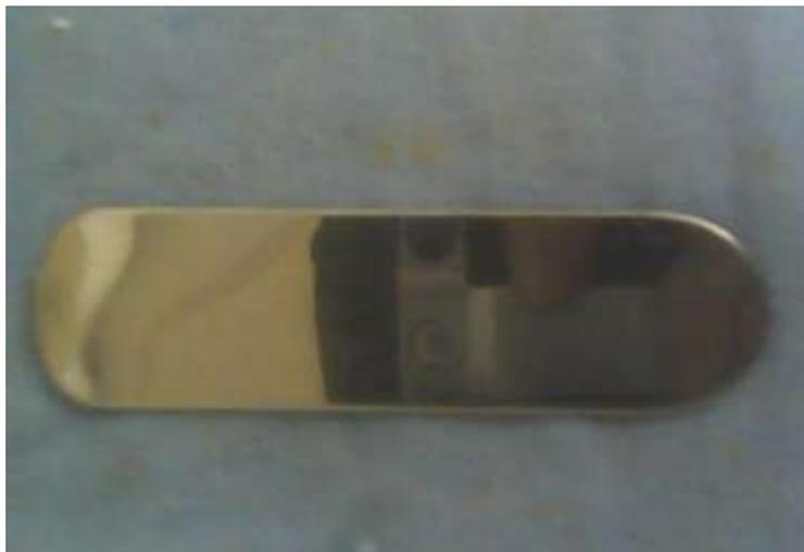
**Figura 22 – Placa polida de aço inoxidável usada como sensor do instrumento**
