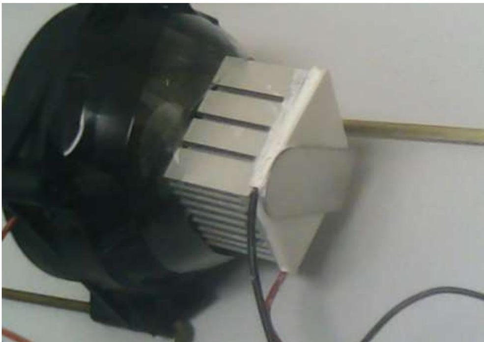
**Figura 24 – Montagem do conjunto com cooler para o dissipador de calor.**
