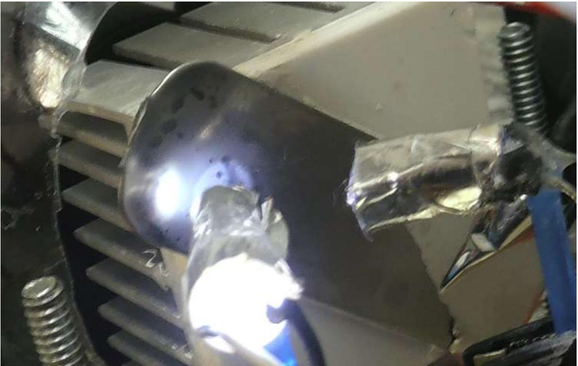
**Figura 36 - Detalhe da placa refletora após condensação em sua superfície**
