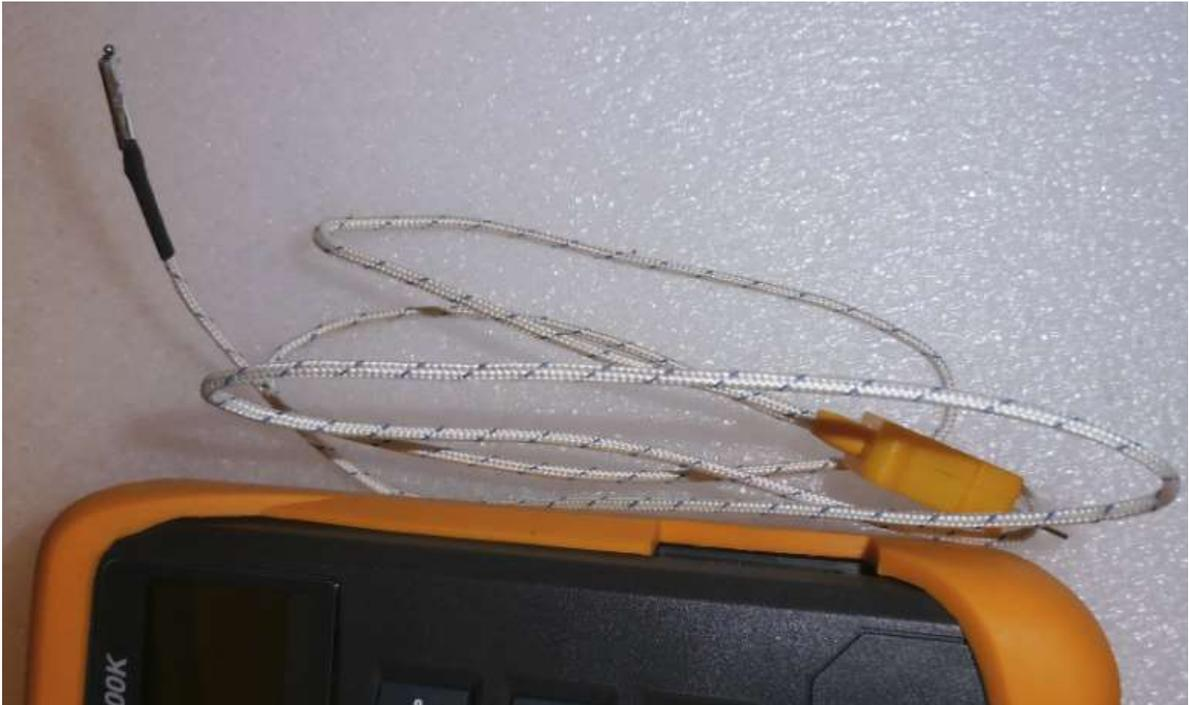
**Figura 29 - Termômetro digital e sensor termopar da placa**
