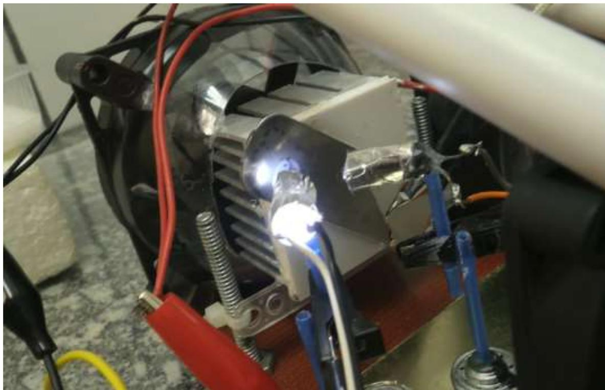
**Figura 37 - Conjunto emissor-detector de luz durante embaçamento da placa**
